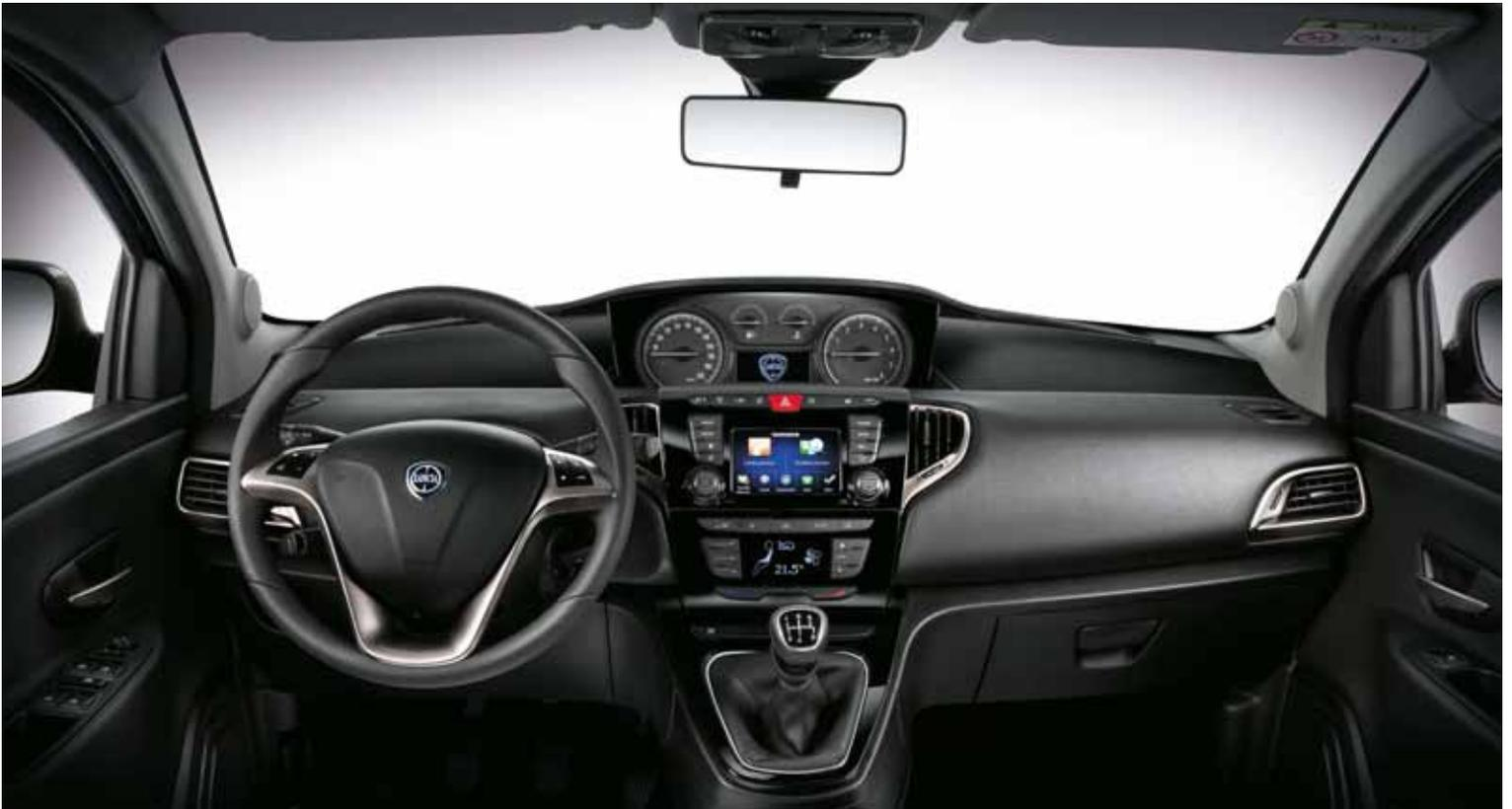
Das Cockpit des neuen Lancia Ypsilon zeichnet sich unter anderem durch neu gestaltete Instrumente aus, die durch eine bessere Ablesbarkeit die Sicherheit erhöhen. Über den mittig angeordneten 5" Touchscreen und das Multifunktionslederlenkrad lassen sich fast alle Fahrzeugfunktionen steuern. Der mit Leder bezogene Schaltknopf ist ergonomisch geformt und sorgt für präzise Schaltvorgänge.
